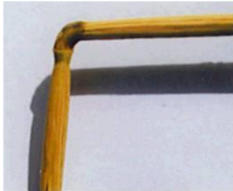
4.6 ábra Elszíneződött és megnyújtott bütyök 90 fokos hajlítással.
