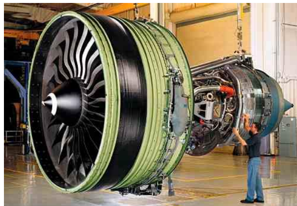
A General Electric GE90-115B gázturbinás repülőgépmotorja, ami a legerősebb gázturbina motor a világon.
